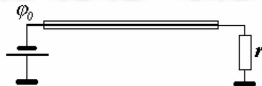
провода поддерживают равным  $\varphi_0 = 100 \text{ В}$ . Ко второму концу провода подключена полезная нагрузка сопротивлением  $r = 100 \text{ Ом}$ .
