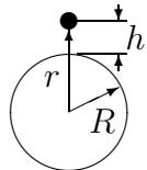
Сила притяжения, действующее на тело массой  $m$  на поверхности Земли равна  $F = mg$ . Так как сила притяжения убывает обратно пропорционально квадрату расстояния от центра Земли  $r$ , то на спутник, находящийся на расстоянии  $r$  от центра Земли, действует сила притяжения
