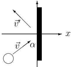
До удара шарика о стенку его составляющая скорости, перпендикулярная стенке, равнялась  $v_x = v \sin \alpha$
