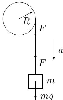
На груз действуют сила тяжести  $mg$  и сила натяжения шнура  $F$ . По второму закону Ньютона ускорение груза равно
