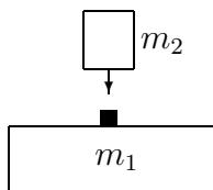
Так как удар молота неупругий, то после удара молот и наковальня будут иметь одинаковую скорость  $v$ . Обозначим скорость молота до удара  $u$ .
