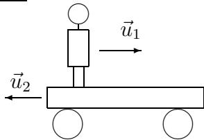
Обозначим скорость человека относительно пола  $u_1$ , а скорость тележки относительно пола  $u_2$ . Относительная скорость с учётом направления  $\vec{u}_1$  и  $\vec{u}_2$ , показанных на рисунке, равна
