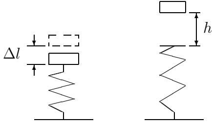
В первом случае пружина сжата силой веса груза  $F = mg$ , отсюда получаем уравнение
