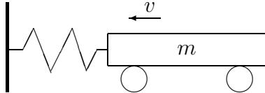
При торможении кинетическая энергия вагона переходит в потенциальную энергию сжатой пружины:
