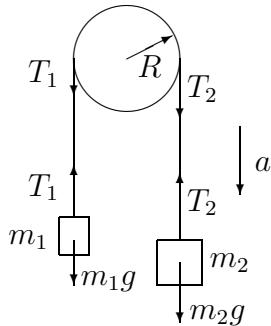
Обозначим  $T_1$  и  $T_2$  – силы натяжения нитей. По основному уравнению вращательного движения
