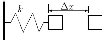
Работа по сжатию пружины равна:
