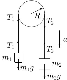
Обозначим линейное ускорение грузов  $a$ . По второму закону Ньютона:
