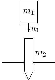
Так как удар бойка по свае неупругий, то после удара скорость  $u_2$  бойка и сваи одна и таже. Обозначим скорость бойка до удара  $u_1$ . По закону сохранения импульса
