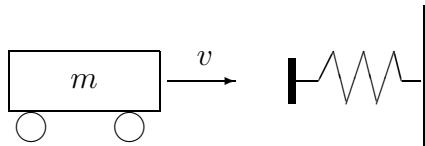
В момент остановки вагона его кинетическая энергия полностью перейдёт в потенциальную энергию сжатия пружины:
