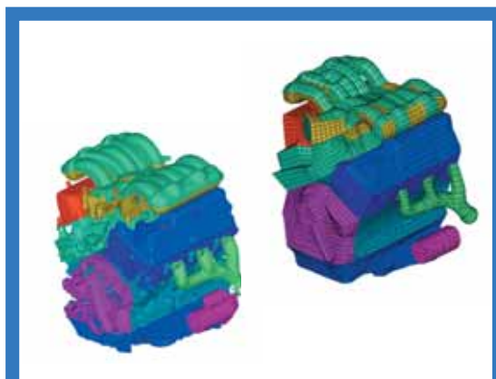
Пример построения расчетной сетки на основе низкокачественной CAD-модели
