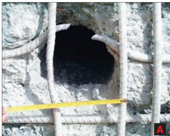
Рис. 2. Сравнение повреждений [1]: а — экспериментальные данные, б — расчет, выполненный в AUTODYN
