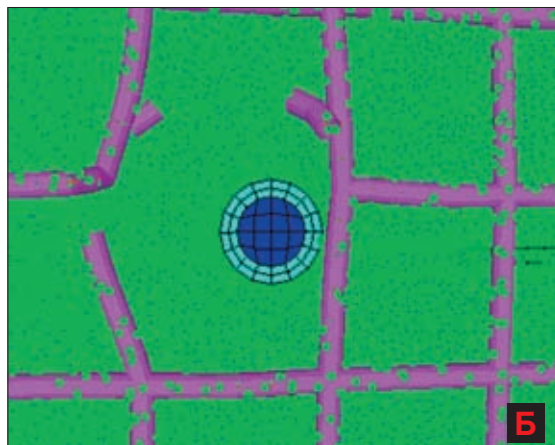
Рис. 2. Сравнение повреждений [1]: а — экспериментальные данные, б — расчет, выполненный в AUTODYN
